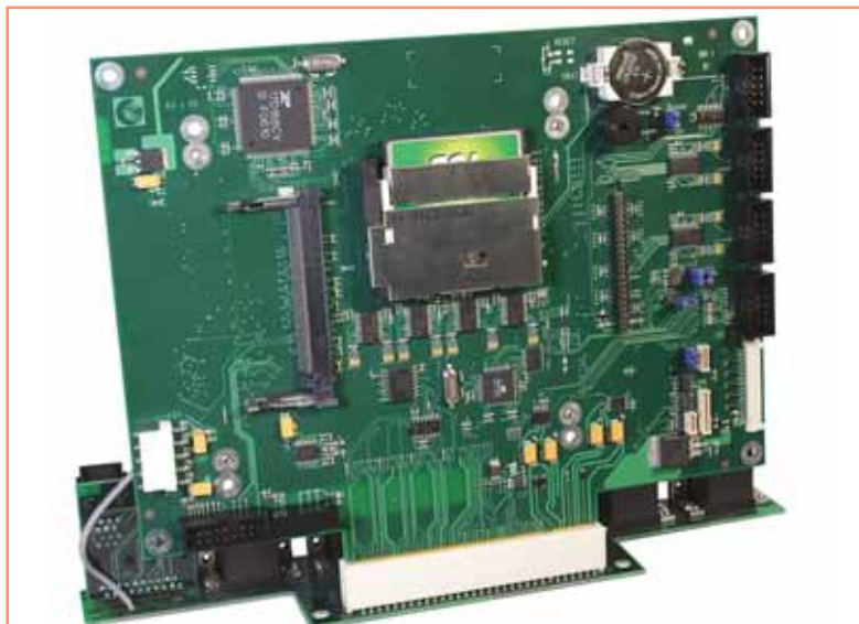
Placa purtătoare particularizat cu COM Kontron ETX-PM. Gama largă de interfețe oferă o mare flexibilitate a aplicației.
